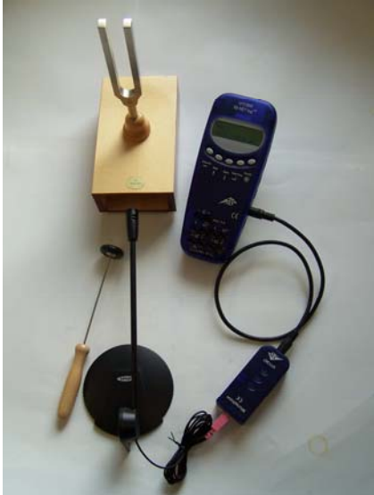
Fig. 1: Messung der Schallwelle einer Stimmgabel
