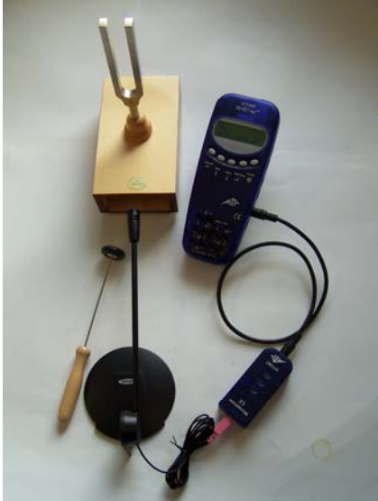
Fig. 1: Medición de la onda sonora de un diapasón
