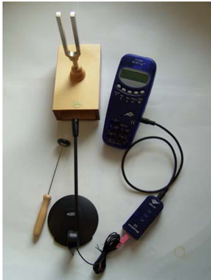
Fig. 1 : Mesure de l'onde sonore d'un diapason
