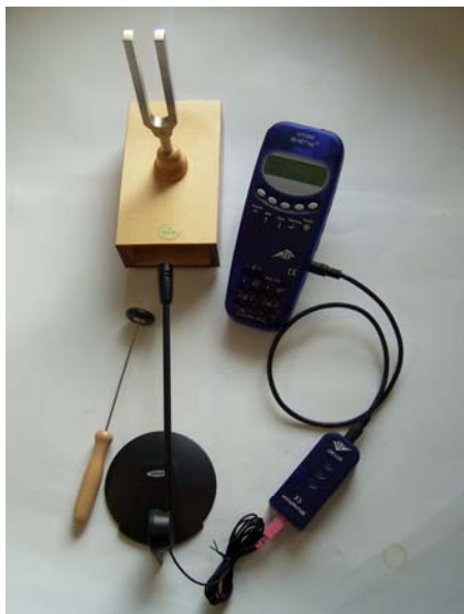
Fig. 1: Medição da onda sonora de um diapasão
