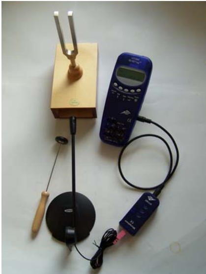
Fig. 1: Misurazione dell'onda sonora di un diapason
