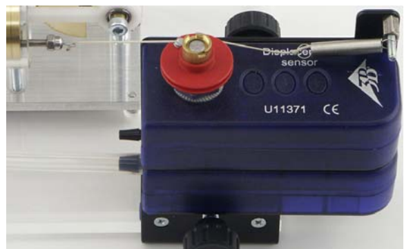
Fig. 7 Soporte de sensores orientado erróneamente – el hilo ‘cuelga’ en caso de la desviación máxima
