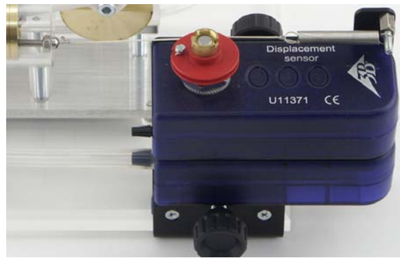
Fig. 6 Alinhamento do suporte de sensores
