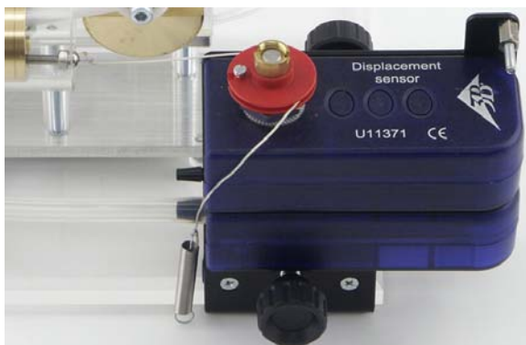
Fig. 4 Positionnement du piston de travail et de la poulie et montage du fil
