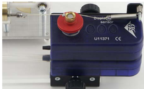
Fig. 7 Support de capteurs mal orienté – dévié au maximum, le fil "se distend"
