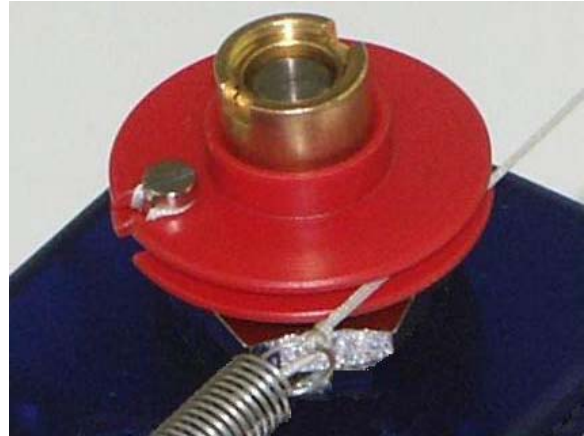
Fig. 5 Passage du fil dans la poulie
