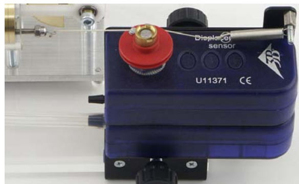
Fig. 7 Falsch ausgerichteter Sensorenhalter – der Faden „hängt“ bei maximaler Auslenkung durch
