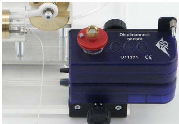
Fig. 3 Fissaggio del filo presso il pistone di lavoro e montaggio del sensore del rilevatore di corsa
