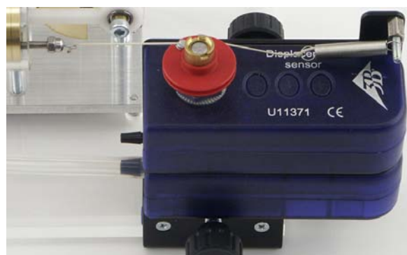
Fig. 7 Erro de alinhamento do suporte de sensores – a corda cedeu demais em deflexão máxima
