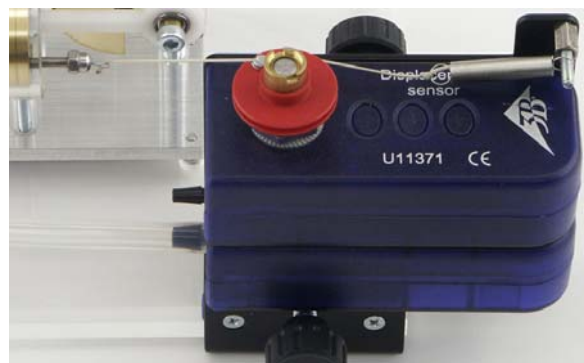
Fig. 7 Portasensori mal allineato – in condizioni di massimo spostamento il filo è lento
