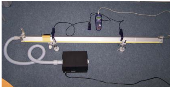
Fig. 1: Misurazione della velocità di un carrello sulla rotaia a cuscinio d'aria in caso di distanza predefinita delle fotocellule.
