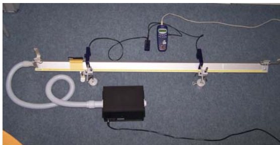
Fig. 1: Medição da velocidade de um deslizador sobre o trilho de colchão de ar numa distância de Barreiras de luz preestabelecida
