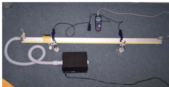
Fig. 1: Messung der Geschwindigkeit eines Gleiters auf der Luftkissenfahrbahn bei vorgegebener Distanz der Lichtschranken
