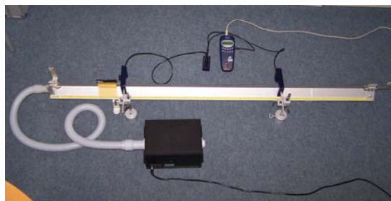
Fig. 1: Medición de la velocidad de un deslizador en el carril neumático con una distancia prefijada entre las puertas fotoeléctricas
