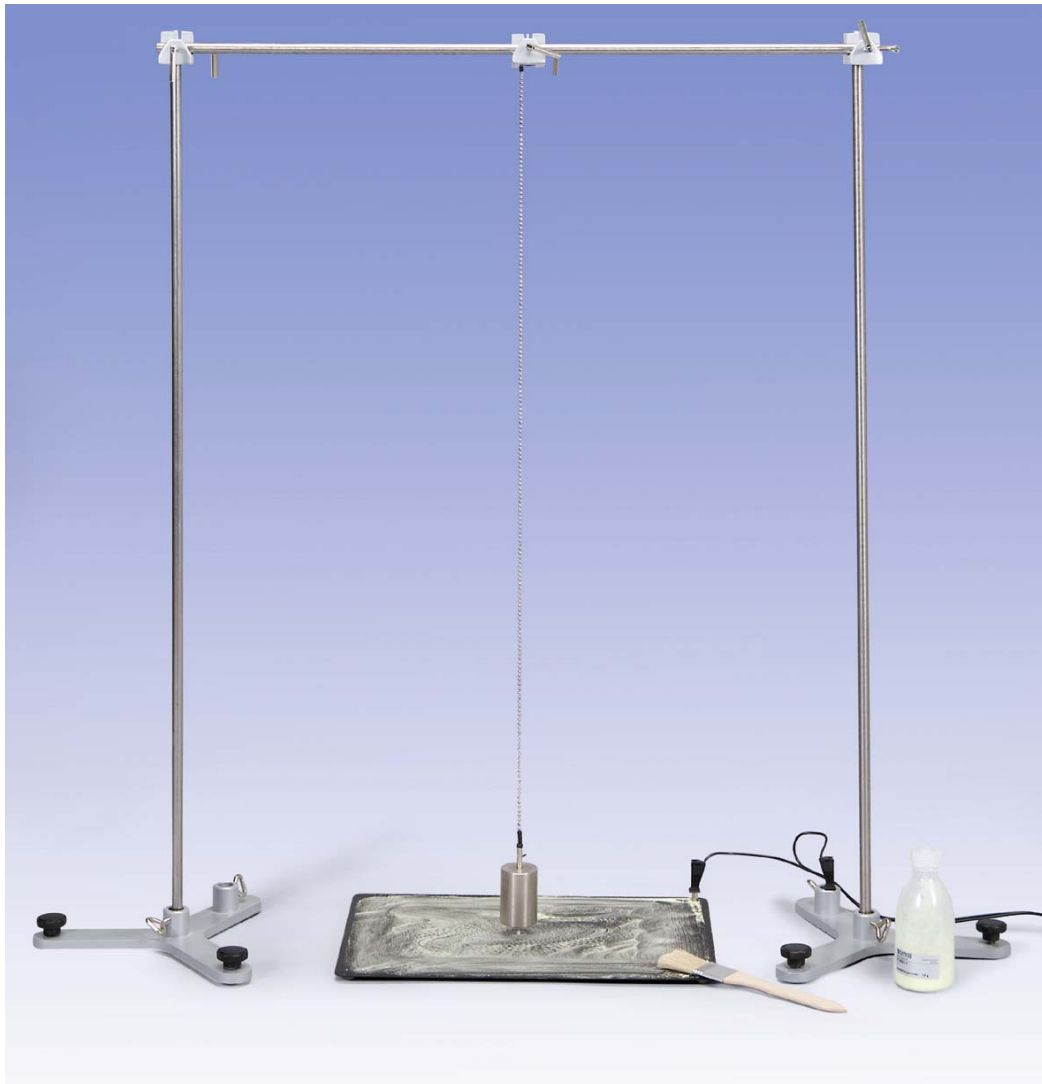
Fig. 2 Experimentieraufbau: Bestätigung des Flächensatzes für Zentralkraftbewegungen (Zweites Kepler'sches Gesetz)
