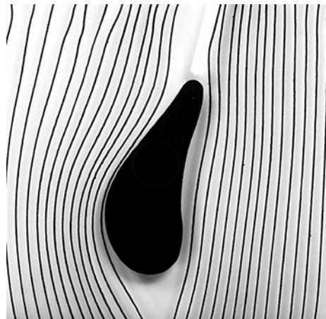
En la zona que se encuentra por debajo del perfil de ala, la dirección y la velocidad del flujo se mantienen constantes. En la zona que se encuentra por encima del perfil, aumenta la velocidad de flujo. Ello genera la presencia de succión en la superficie superior del perfil.
