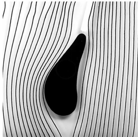
Unterhalb des Tragflächenprofils bleiben Richtung und Geschwindigkeit der Strömung konstant. Oberhalb des Profils nimmt die Strömungsgeschwindigkeit zu. Daraus resultiert ein Sog an der oberen Fläche des Profils.
