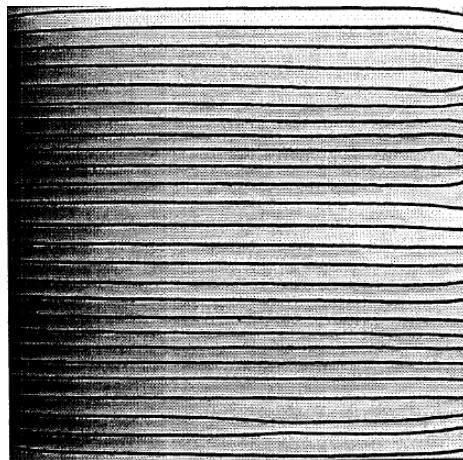
In einer geradlinigen laminaren Strömung laufen alle Stromlinien parallel. Richtung und Geschwindigkeit der Strömung sind an allen Stellen gleich
