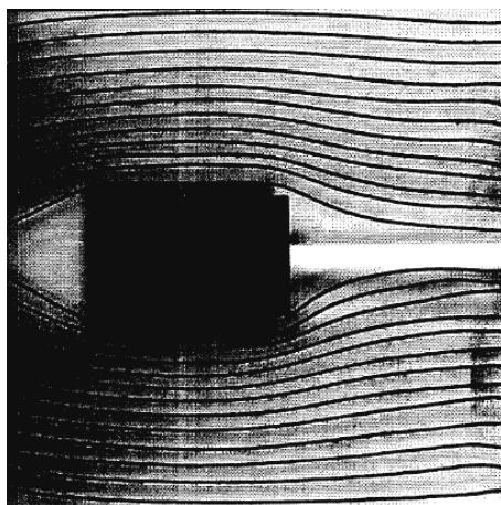
Dans le cas de l'écoulement de contournement autour d'un parallélépipède rectangle, les lignes de courant se rétrécissent dans l'écoulement d'air. La vitesse d'écoulement augmentant alors. Le corps une fois passé, la vitesse d'écoulement diminuera.
