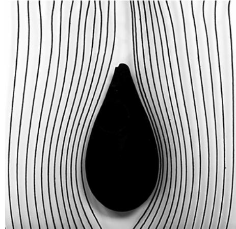
Bei der Umströmung eines tropfenförmigen Körpers verengen sich die Luftstromlinien. Dabei nimmt die Strömungsgeschwindigkeit zu. Ist der Körper passiert, nimmt die Strömungsgeschwindigkeit wieder ab.
