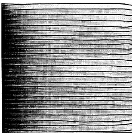
En el caso del flujo laminar rectilíneo, todas las líneas de corriente de aire transcurren de forma paralela. La dirección y la velocidad de la corriente son iguales en todas partes.
