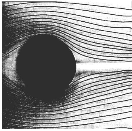
Bei der Umströmung einer Kugel verengen sich die Luftstromlinien. Dabei nimmt die Strömungsgeschwindigkeit zu. Ist der Körper passiert nimmt die Strömungsgeschwindigkeit ab.
