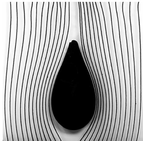
No caso do desvio de corrente por um corpo em forma de gota as linhas de corrente se estreitam. Ao mesmo tempo, a velocidade das correntes aumenta. Depois de ter passado o corpo, a velocidade volta a reduzir-se.
