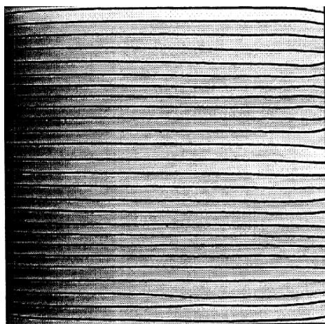
Numa corrente retilínea laminar as linhas de corrente seguem percursos paralelos uns aos outros. A direção e a velocidade das correntes são as mesmas em todos os pontos.
