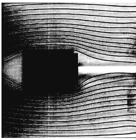
Cuando la corriente fluye alrededor de un paralelepípedo, las líneas aerodinámicas se estrechan. Durante dicho proceso, aumenta la velocidad de flujo. Una vez que el cuerpo ha quedado atrás, la velocidad de flujo vuelve a disminuir.
