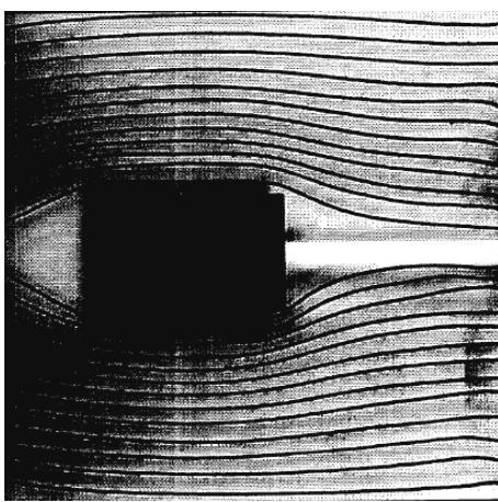
Sottoponendo una quadrato ad un flusso circolare, le linee di corrente d'aria si restringono. La velocità della corrente aumenta. Dopo aver superato il corpo, la velocità della corrente diminuisce.
