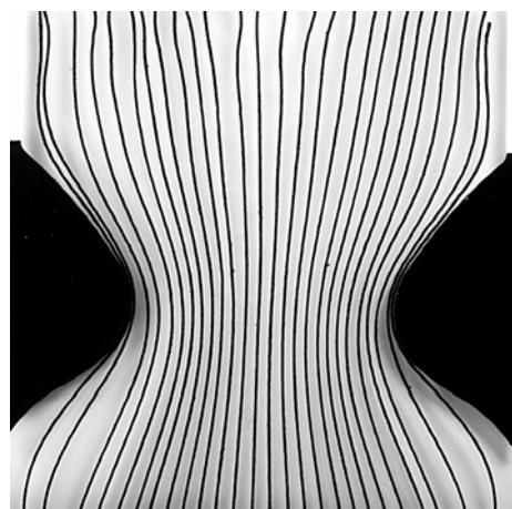
Bei diesem Versuch werden zwei Strömungskörper in das Gerät gehalten.
