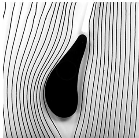
Sotto il profilo della superficie portante direzione e velocità della corrente rimangono costanti. Sopra il profilo la velocità della corrente aumenta. Di conseguenza nella parte alta della superficie del profilo si forma un risucchio.
