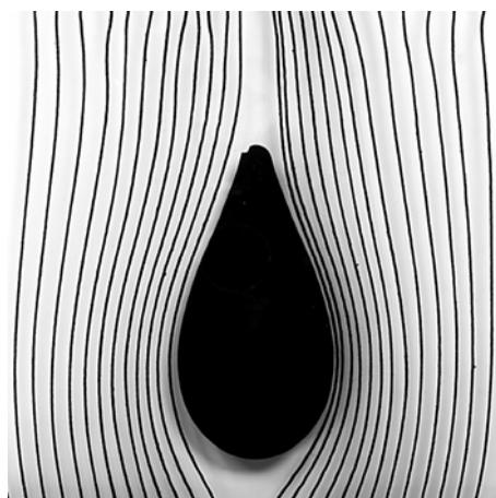
Sottponendo ad un flusso circolare un corpo con intaglio a goccia, le linee di corrente d'aria si restringono. La velocità della corrente aumenta. Dopo aver superato il corpo, la velocità della corrente diminuisce di nuovo.
