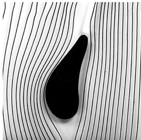
Au-dessous du profil de surfaces portantes, la direction et la vitesse d'écoulement resteront constantes. La vitesse d'écoulement augmentera au-dessus du profil. Il en résultera un remous à la surface supérieure du profil.
