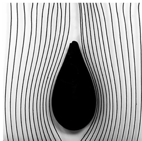
Dans le cas de l'écoulement de contournement autour d'un corps de forme aérodynamique, les lignes de courant se rétrécissent dans l'écoulement d'air. La vitesse d'écoulement augmentant alors. Le corps une fois passé, la vitesse d'écoulement diminuera de nouveau.
