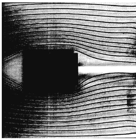
Bei der Umströmung eines Quaders verengen sich die Luftstromlinien. Dabei nimmt die Strömungsgeschwindigkeit zu. Ist der Körper passiert nimmt die Strömungsgeschwindigkeit ab.
