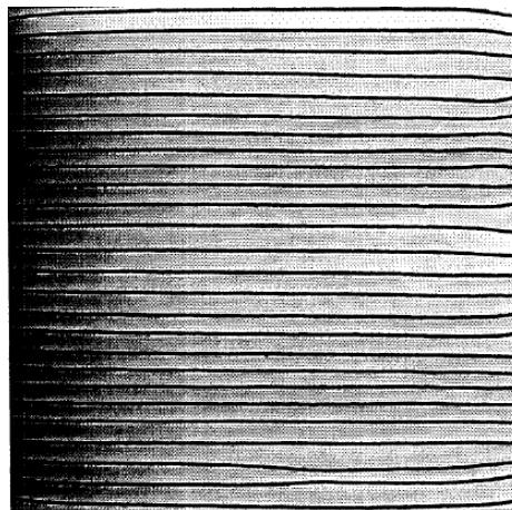
Dans le cas d'un écoulement laminaire engendré par un mouvement rectiligne, toutes les lignes de courant s'alignent parallèlement. La direction et la vitesse d'écoulement sont en toutes places égales.
