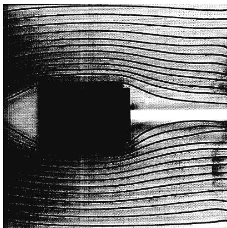
Ao contornar uma esfera as linhas se estreitam. Ao mesmo tempo, a velocidade das correntes aumenta. Depois de ter passado o corpo, a velocidade volta a reduzir-se.
