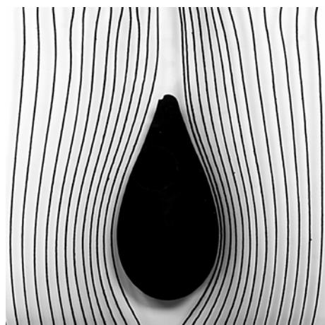
Cuando la corriente fluye alrededor de un cuerpo con forma de gota, las líneas aerodinámicas se estrechan. Durante dicho proceso, aumenta la velocidad de flujo. Una vez que el cuerpo ha quedado atrás, la velocidad de flujo vuelve a disminuir.
