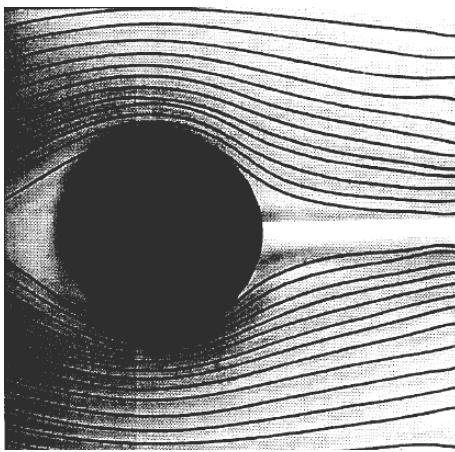
Dans le cas de l'écoulement de contournement autour d'une sphère, les lignes de courant se rétrécissent dans l'écoulement d'air. La vitesse d'écoulement augmentant alors. Le corps une fois passé, la vitesse d'écoulement diminuera.
