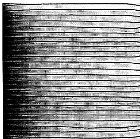
In una corrente laminare rettilinea tutte le linee di corrente corrono parallele. La direzione e la velocità della corrente sono uguali in tutti i punti.
