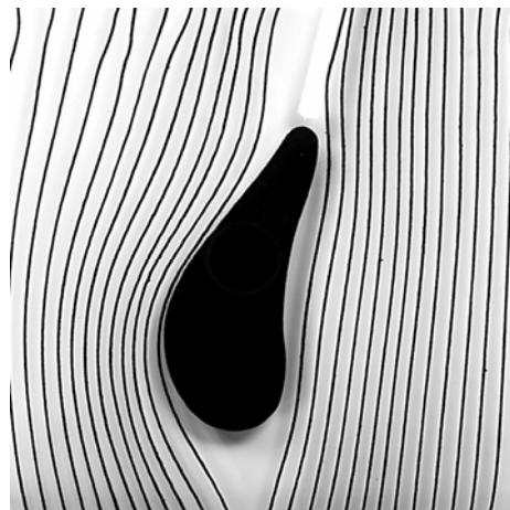
Por baixo do perfil de asa, a direção e a velocidade da corrente permanece constante. Acima do perfil, a velocidade da corrente aumenta. Por isso, ocorre um feito de sucção na superfície superior do perfil.
