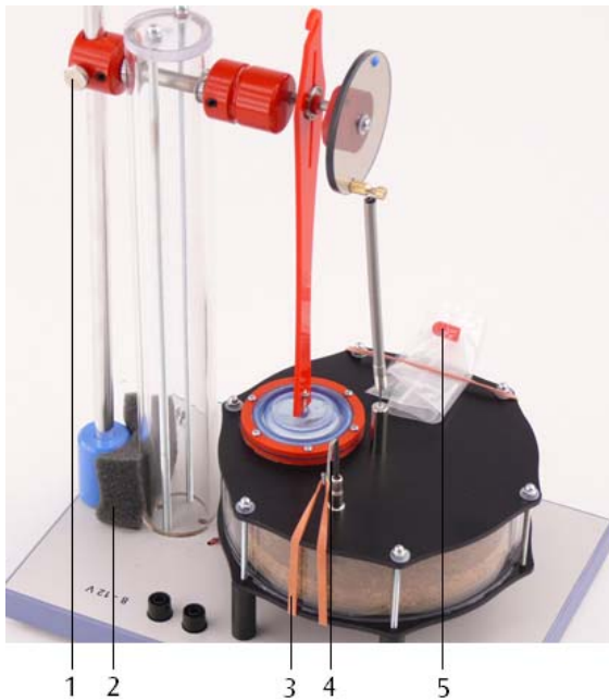
Fig. 7 Stirling-Motor in gesichertem Zustand
