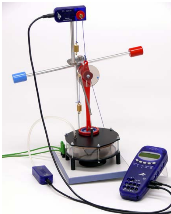
Fig. 9 Struttura sperimentale per la registrazione del diagramma pV
