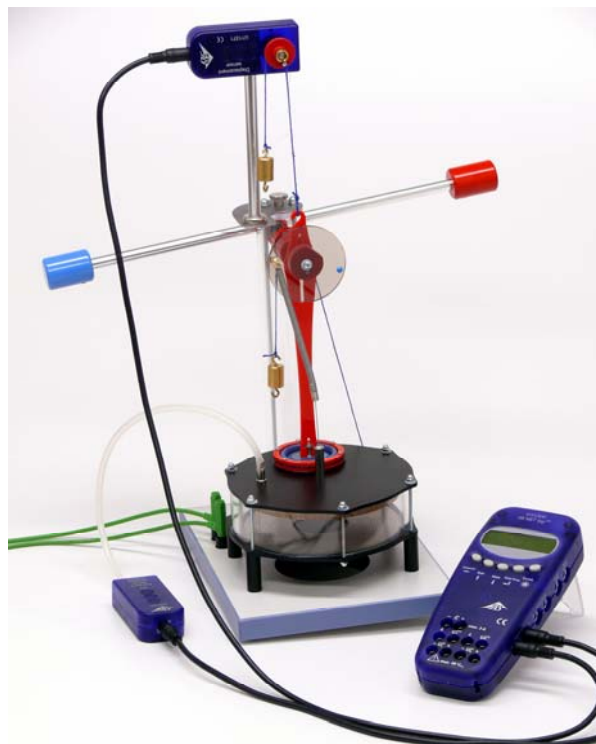
Fig. 9 Experimenteller Aufbau zur Aufnahme des pV-Diagramms
