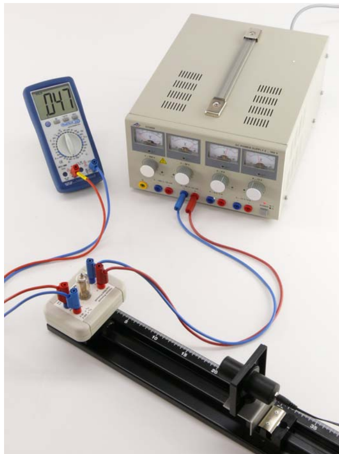
Fig. 4 Montagem da experiência para a comprovação do efeito fotoelétrico
