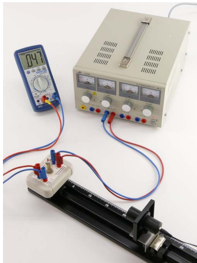
Fig. 2 Experimentieraufbau zum Nachweis des Fotoelektrischen Effekts
