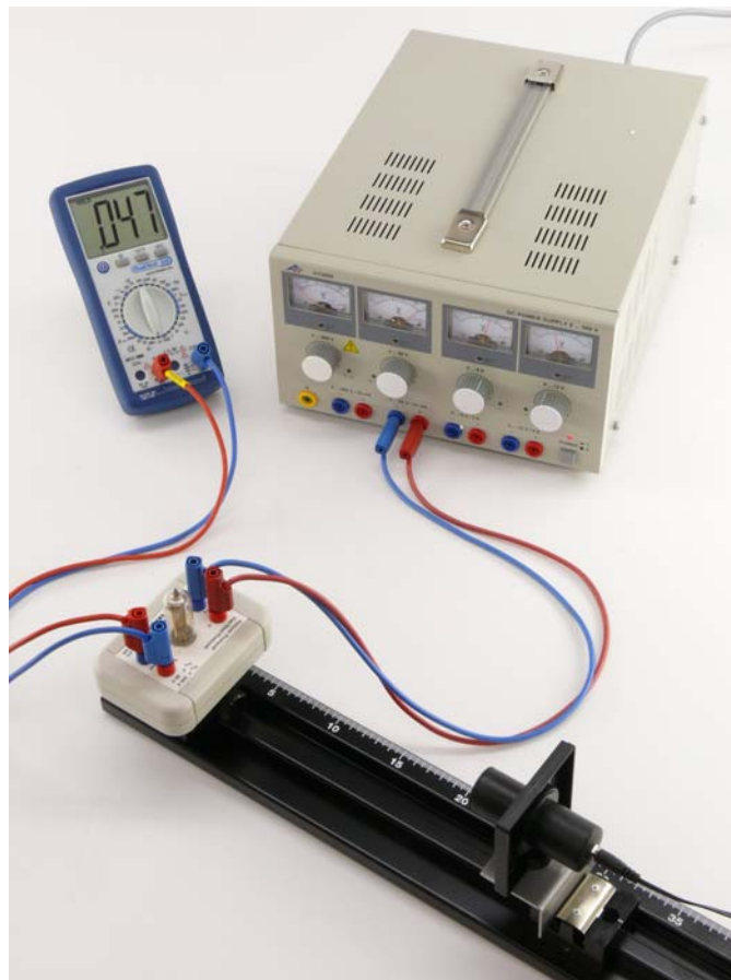
Fig. 4 Montaje experimental para la comprobación del efecto fotoeléctrico
