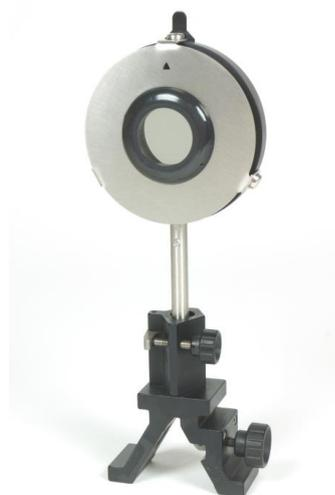
Fig. 1: Accesorio de polarización montado en la placa de cuarto de onda.
