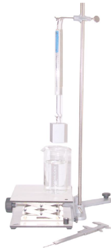
Fig. 1 Determinación del empuje ascensional sobre un paralelepípedo.
