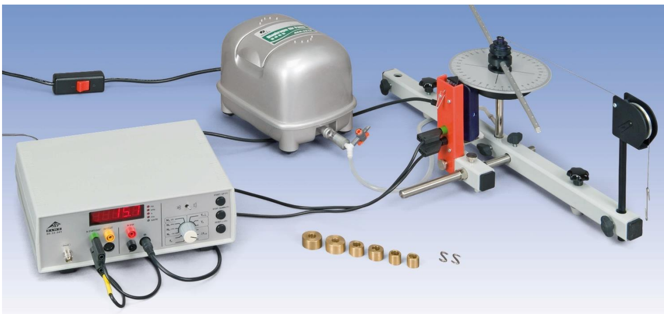
Fig. 1: Montaje de medición para el estudio de movimientos de rotación uniformemente acelerados
