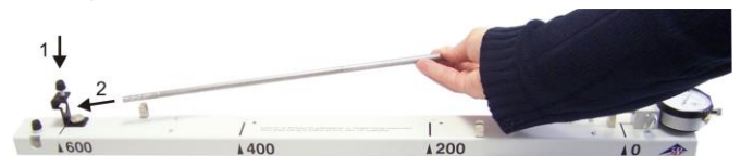
Fig. 6: El asiento fijo se sujeta con el tornillo moleteado en la marca 600 del aparato de dilatación de longitud. El tubo de prueba de acero se coloca con su extremo abierto sobre el asiento fijo.
