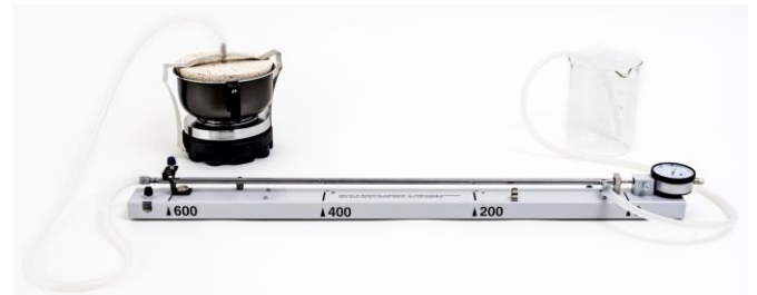
Fig. 12: Montaje con generador de vapor
