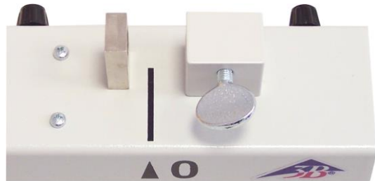
Fig. 4: Se atornilla el adaptador para el reloj comparador.
