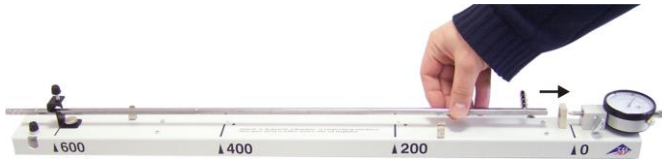
Fig. 7: El tubo de prueba se coloca con el extremo cerrado en el asiento guía. Se debe tener cuidado de que la brida muestre hacia atrás.
