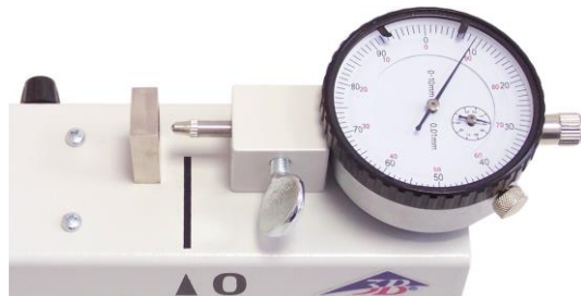
Fig. 5: Se inserta el reloj comparador completamente en el adaptador y se fija con el tornillo de mariposa.
