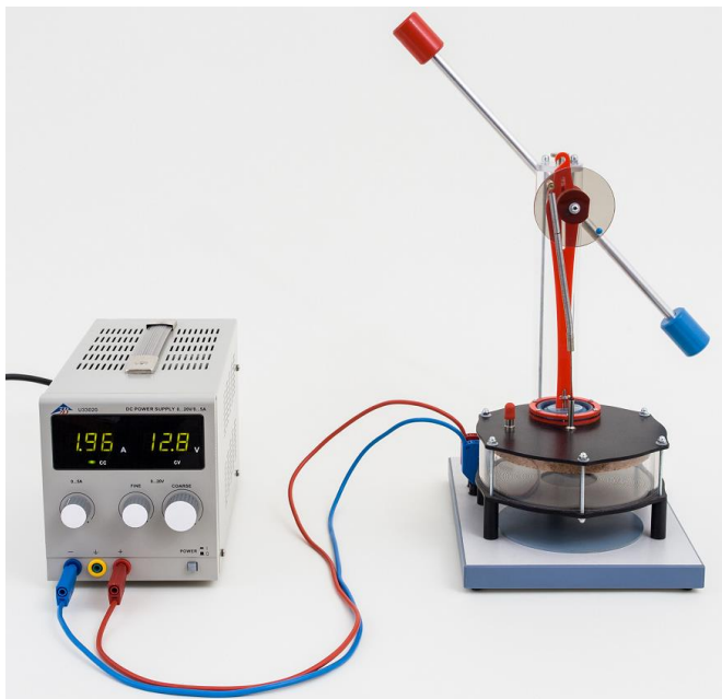
Fig. 5: Montaje para el servicio del motor de aire caliente como máquina motriz térmica por medio de calefacción eléctrica.
