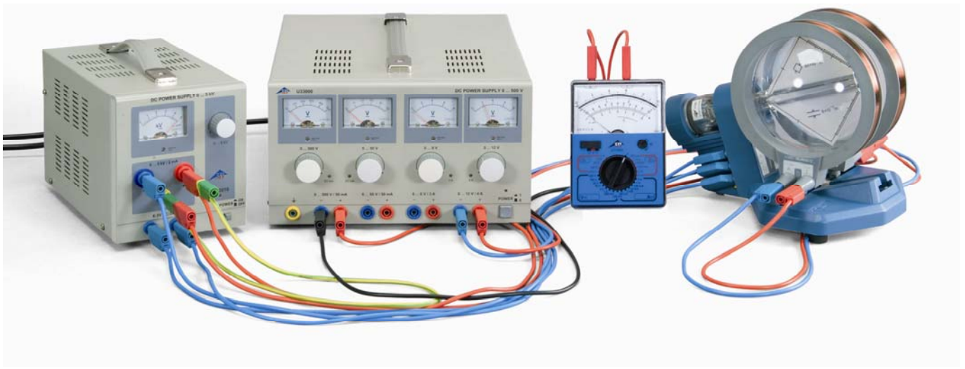
Fig. 2: Montaje experimental para el estudio de la desviación de electrones en un campo eléctrico y en un campo magnético
